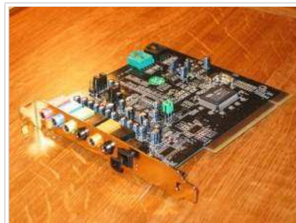
Tarjeta basada en el chipset VIA Envoy
